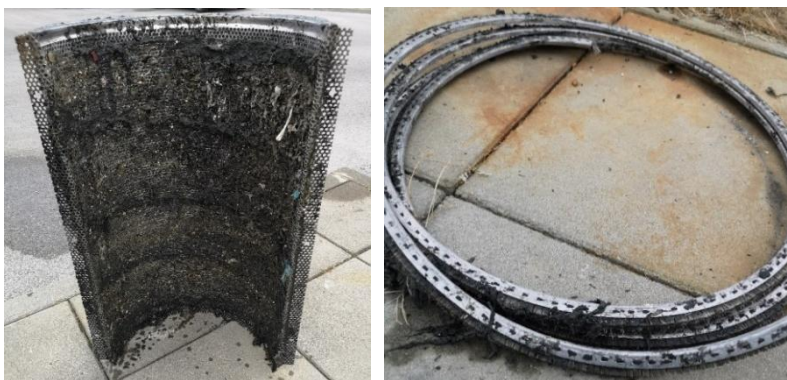
Slika: Zamašena sita in obrabljene ščetke
