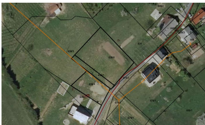
Slika 11: Prikaz opremljenosti z omrežjem elektronskih komunikacij (Vir: https://gis.iobcina.si , maj 2019)
